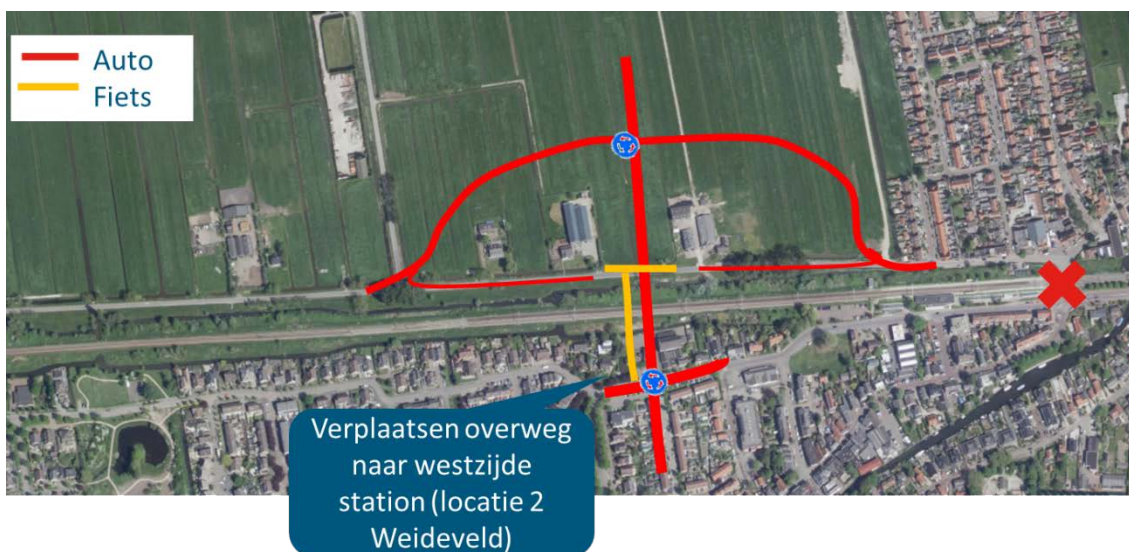
Figuur 10: B - Verplaatsen overweg naar westzijde station.
