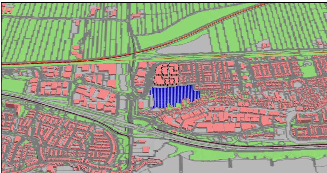
Afbeelding 10 3D-weergave geluidsmodel railverkeerslawaai bouwvlakken bestemmingsplan
