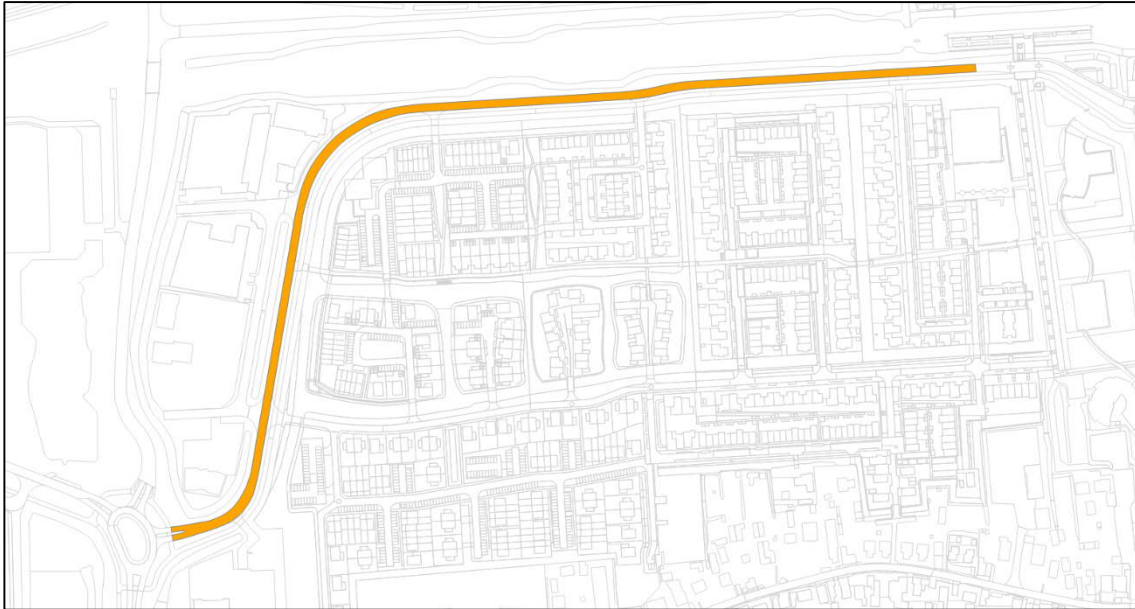
Afbeelding 7 Aan te leggen stil wegdek (dunne deklaag type A of SMA-NL8G+) op Schapedrift
