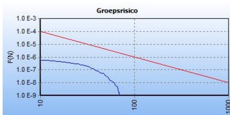
Figuur 2.5: fN-curve buisleiding W-528-01-deel-1, voor planrealisatie
