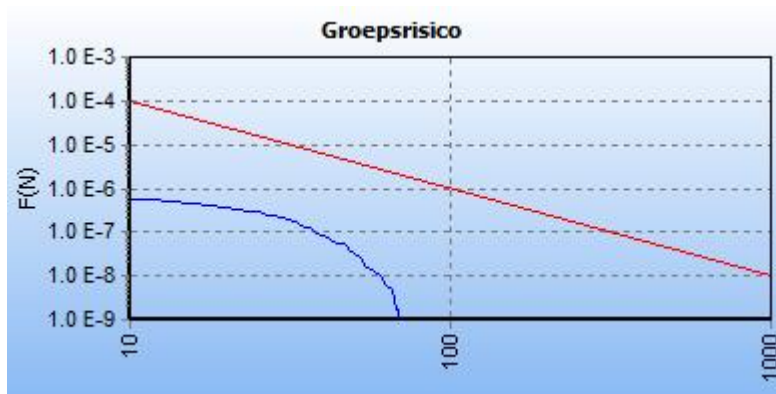
Figuur 2.9: fN-curve buisleiding W-528-01-deel-1, na planrealisatie
