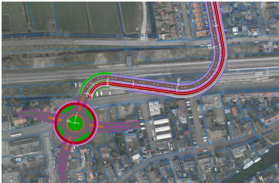
Figuur 3: Ontwerp onderdoorgang met helling 100 meter, vlakke aansluiting op de rotonde en bochtstralen van 40 meter
