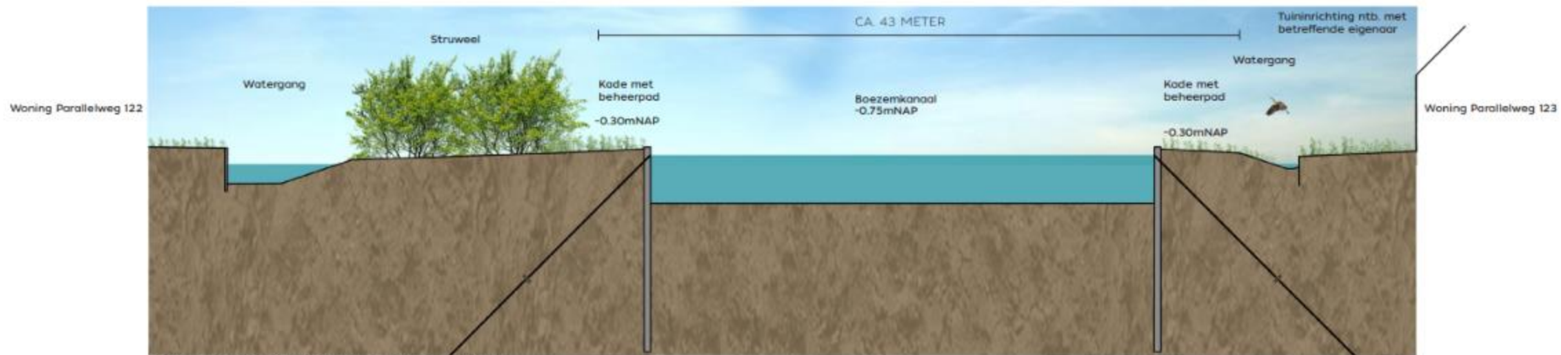
Profiel 1: midden bij damwanden incl. verankering
