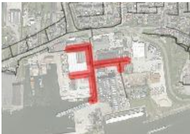
Figuur 2 In 2024 is de riolering in het gebied de Havengebied 60 jaar oud. De leidingen zijn geïnspecteerd en moeten binnen nu en 10 jaar vervangen worden in verband met schadebeelden. Dit geldt alleen voor DWA/VWA. Het HWA heeft geen schade.
